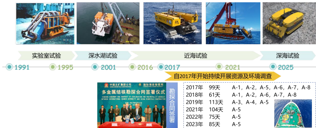
图 1.4-1 中国五矿多金属结核采矿车试验与发展情况
