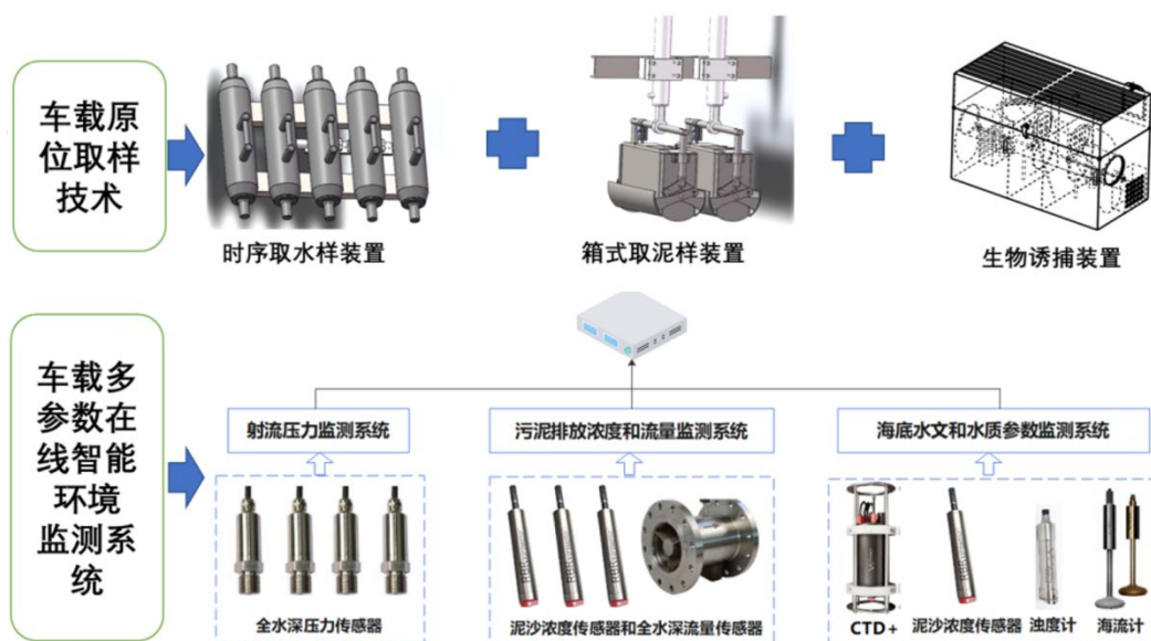
图 10.3-2 采矿车的多参数在线环境监测系统的主要分系统构成示意图
