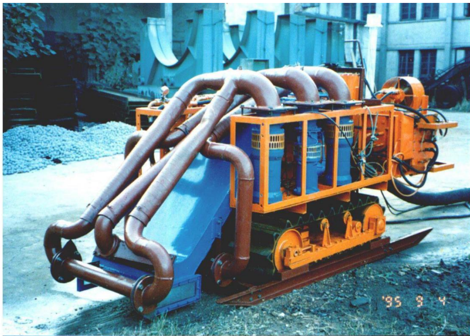
图 1.4-2 多金属结核水力式集矿原理样机
